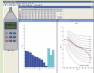
그림 3 1/1 옥타브분석 및 룸노이즈 NC값 측정화면
