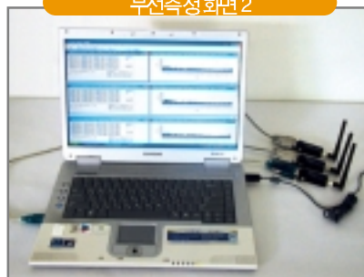
1대의 컴퓨터에서 여러대의 소음측정기(SC-310)를 무선으로 동시에 측정, 모니터링하는 화면
